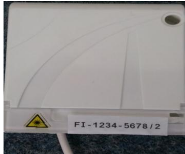
Figure 22: repérage sur la PTO déportée
